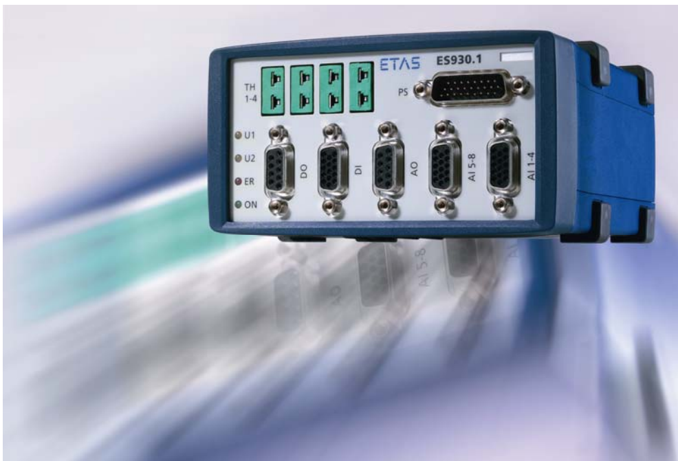
Abbildung: Ein echter I/O-Allrounder – das Multi-I/O-Modul ES930 von ETAS.
