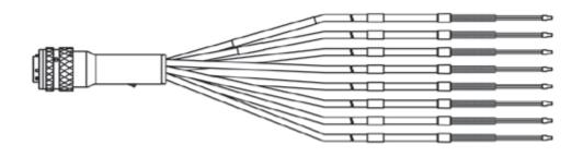
Câble diviseur d'entrée analogique, Souriau 8ST12-35 - 8xBNC (22mc-8x2fc), 0m2
