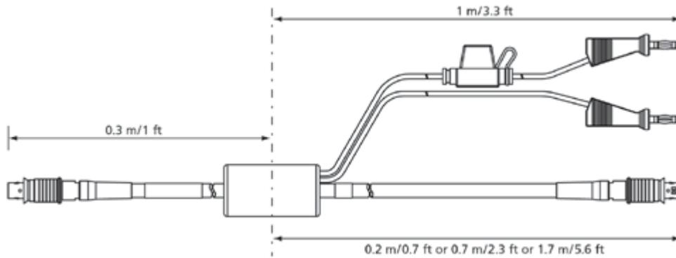
Câble de connexion Ethernet et d'alimentation pour chaînes de modules, Lemo 1B FGL - Lemo 1B FGA - Fiches banane de sécurité (8fc-8mc+2mc), 0m5      CBEP4305.1-0m5      F-00K-110-030
