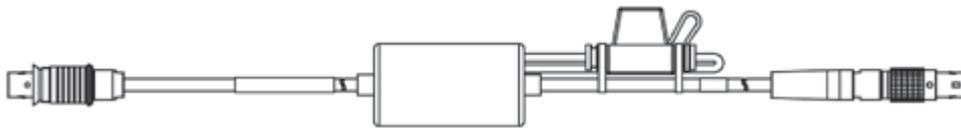
Câble de connexion Ethernet pour chaînes de modules, Lemo 1B FGA - Lemo 1B FGL (8mc-8fc), 0m45 CBE430.1-0m45 F-00K-104-923
